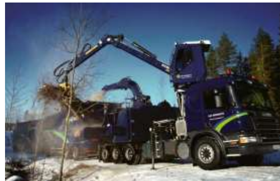
Подрібнювач, встановлений на вантажному автомобілі
