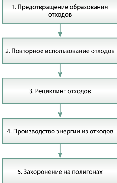
Рис. 1. Иерархия принципов интегрированной системы управления отходами
