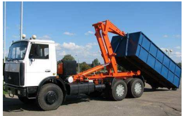
Рис. 2.4.4. Мультиліфт з контейнером для тріски.
