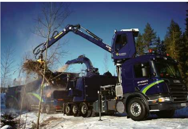
Рис. 2.4.3. Мобільний подрібнювач на шасі вантажного автомобіля.
