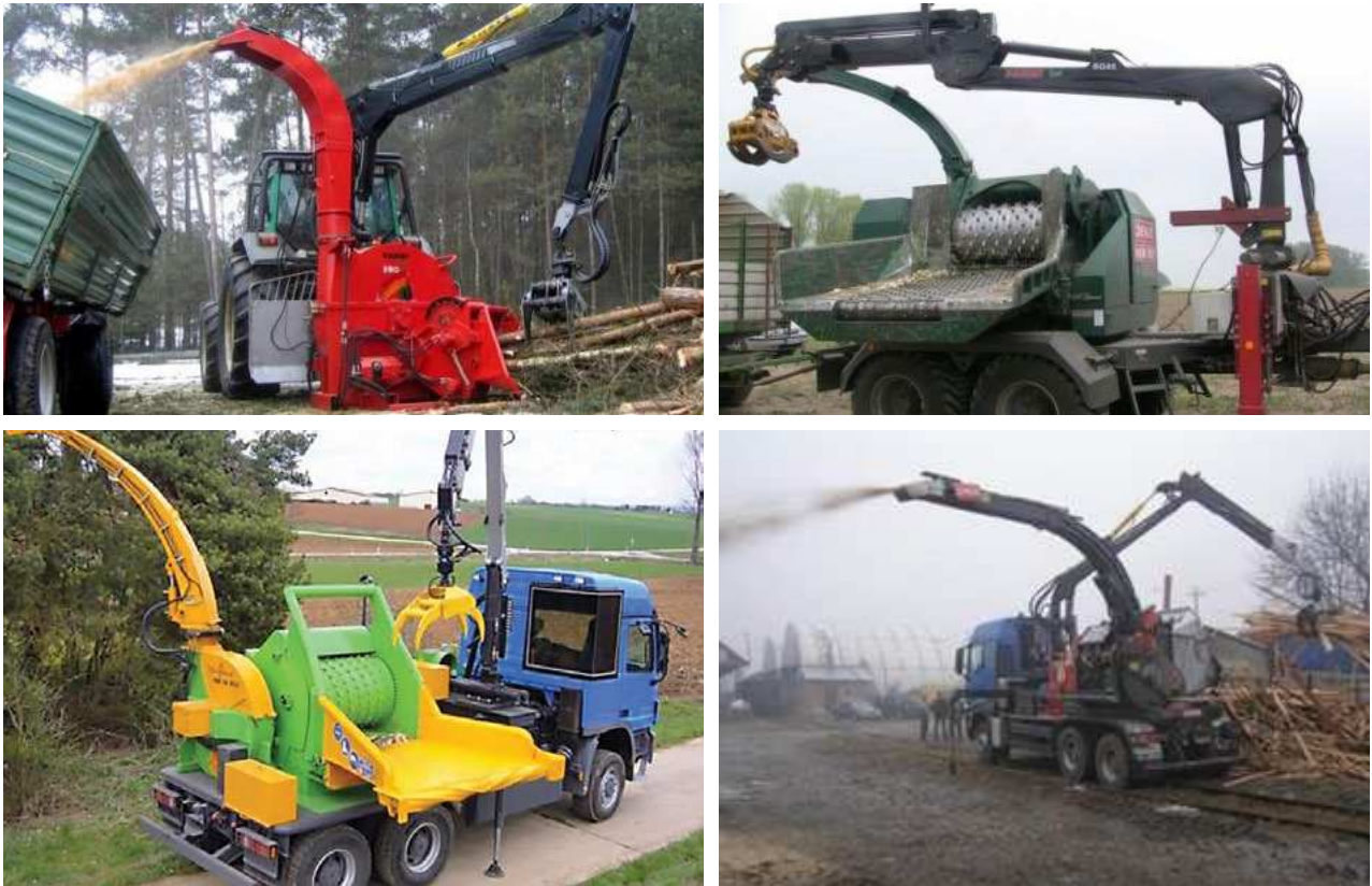
Рис. 2.4.10. Зовнішній вигляд мобільних подрібнювачів відходів деревини.
