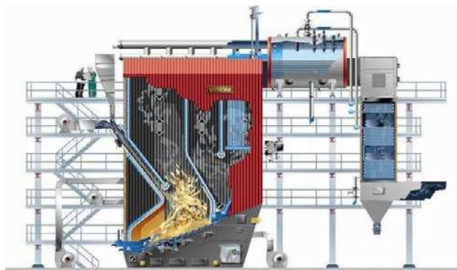
Рис. 4.4. Жаротрубний котел типу JNO-HD.
