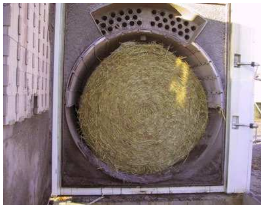
а) спалювання цілих циліндричних тюків
