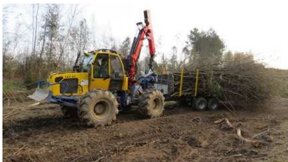
Рис. 2.4.11. Вивезення та подрібнення деревних відходів.
