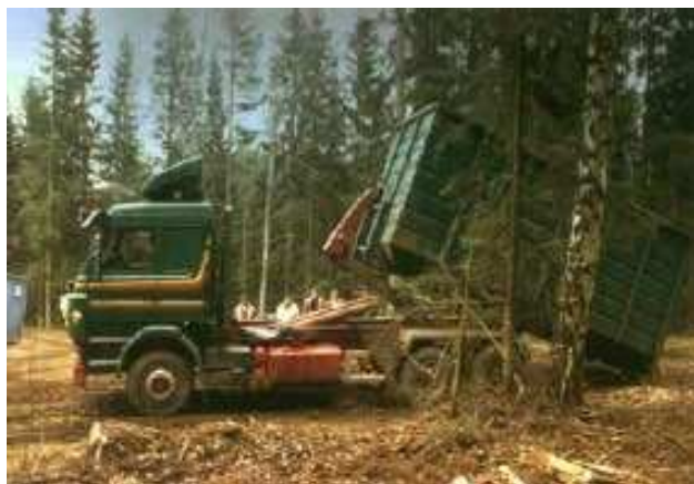
Рис. 2.4.8. Процес спорожнення контейнера мобільного подрібнювача та подальше навантаження контейнера на тягач.
