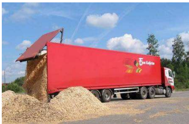
Рис. 2.4.7. Види вантажних причепів для перевезення подрібненої деревини.
