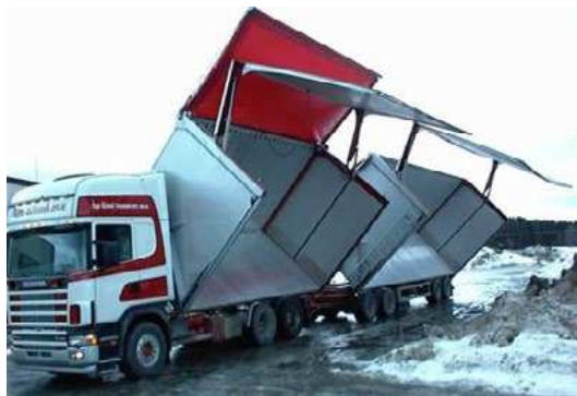
Рис. 2.4.6. Види вантажних причепів для перевезення подрібненої деревини.
