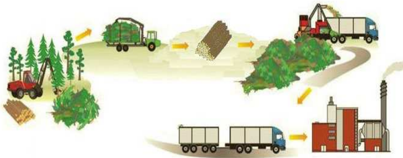
Рис. 2.2.1. Принципова схема логістики тріски.
