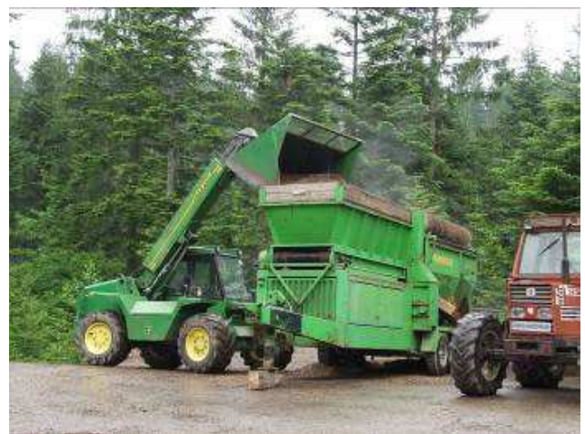
Рис. 2.4.5. Ковшовий навантажувач подрібненої деревини.
