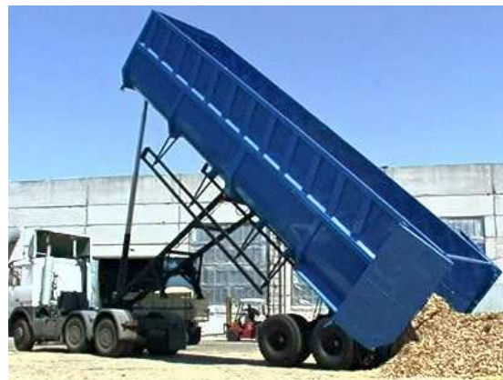
Рис. 2.4.7. Види вантажних причепів для перевезення подрібненої деревини.
