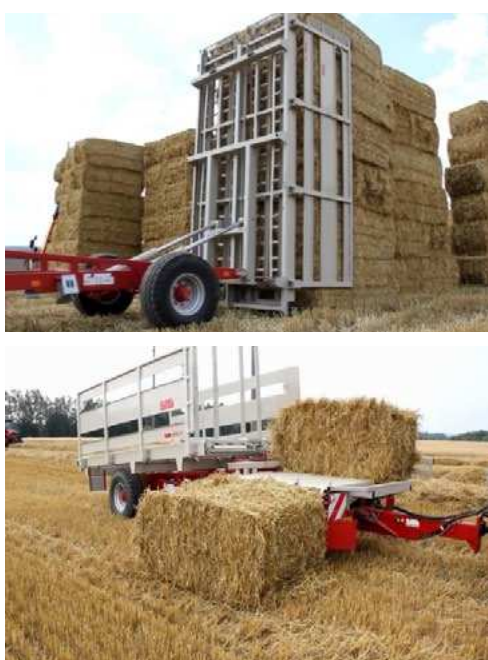
Рис. 2.5.6. Спеціалізовані підбирачі великих прямокутних тюків соломи.
