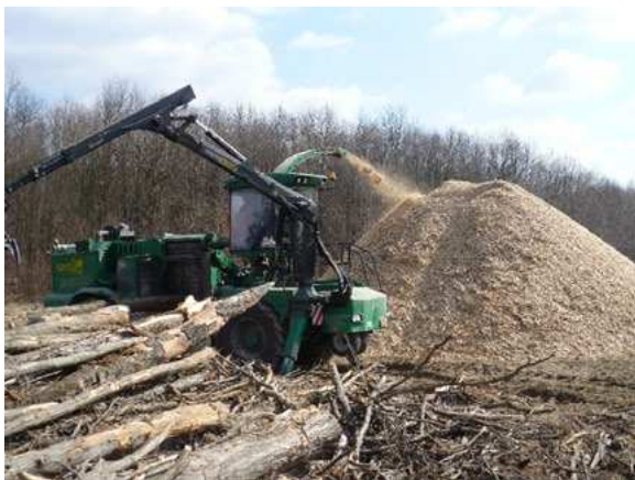
Рис. 2.4.1. Техніка для подрібнення та вивезення деревини.
