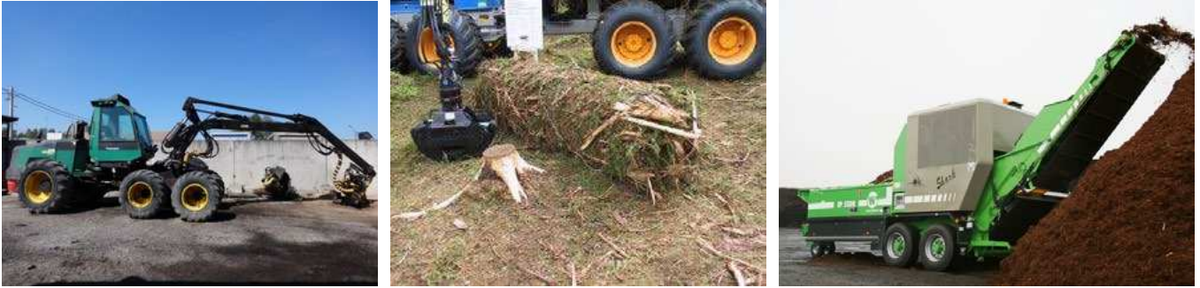
Рис. 2.4.2. Зліва направо: харвестер, в'язанки відходів рубки, мобільний подрібнювач.
