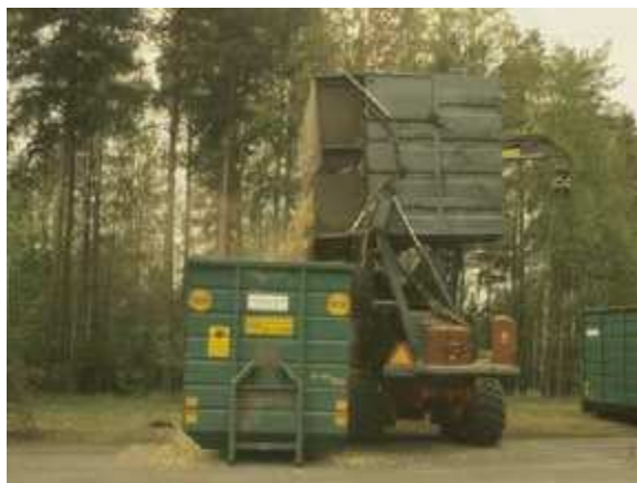
Рис. 2.4.8. Процес спорожнення контейнера мобільного подрібнювача та подальше навантаження контейнера на тягач.
