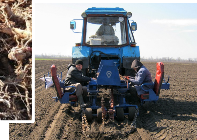
Посадкова машина СМ-2, 2-рядна, ІБКіЦБ НААНУ, Продуктивність: 0,4-0,5 га/год, Відділ технологій вирощування біоенергетичних культур
