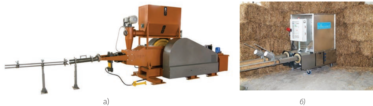
Рис. 4.2. Приклади прес-брикетувальників з поршневым (а) і шнековим (б) робочим органом.
