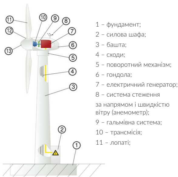
Рис. 4.8. Схема трилопатевого вітрогенератора з горизонтальною віссю обертання
