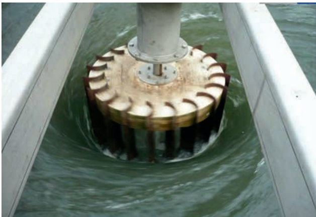
в) Міні/мікро-ГЕС з вертикальним ротором
